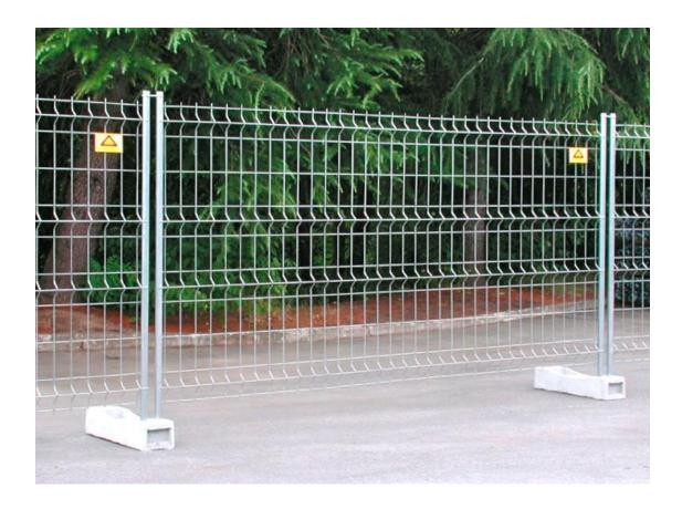
BASTIDORES: De 3.50 x 1,90 m de malla electrosoldada formando reticula de 150x125/3.40 mmØ soldada a tubos de 40 mmØ en ambos extremos.
